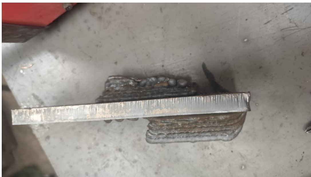
Рисунок 1.5 – Сравнение стабильной и не стабильной подачи защитного газа (сверху валик образовавшийся при неравномерной подаче газа, снизу – после очищения сопла и равномерной подаче газа)
