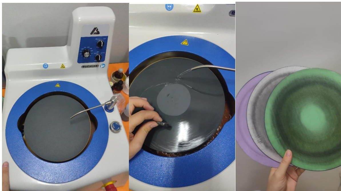
Рисунок 2.4 - Шлифовка проводилась на полировально-шлифовальном станке Buehler
