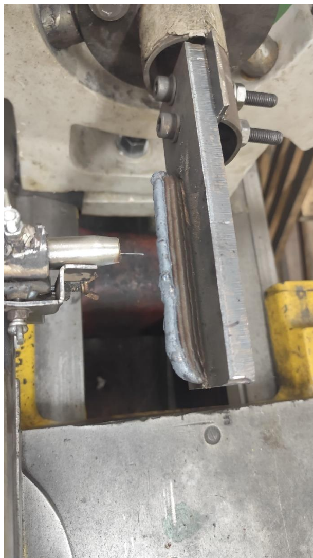
Рисунок 2.2 – Многослойный валик, образованный методом WAAM
