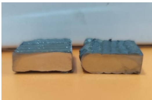
Рисунок 2.3 – Образцы, отшлифованные и отполированные с одной стороны
